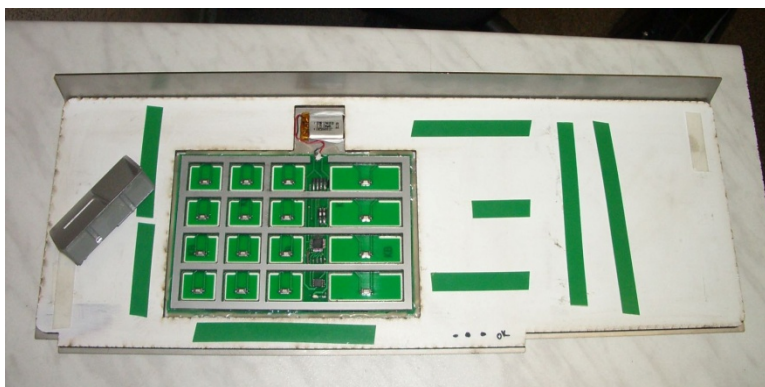
Оборотная сторона накладной клавиатуры и считывателя магнитной полосы карты
